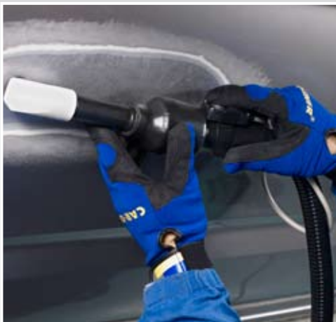
Chauffes de rétreint sur panneaux aluminium ou acier
