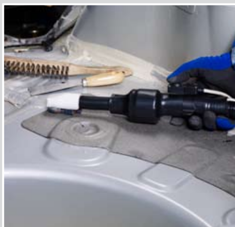
Démontage des boulons et écrous grippés sur suspension, crémaillère de direction
