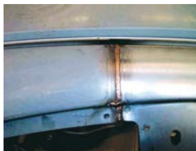
Le BRASAGE MIG est une technique douce à basse température qui permet de conserver au mieux le revêtement anti corrosion et la rigidité des tôles
